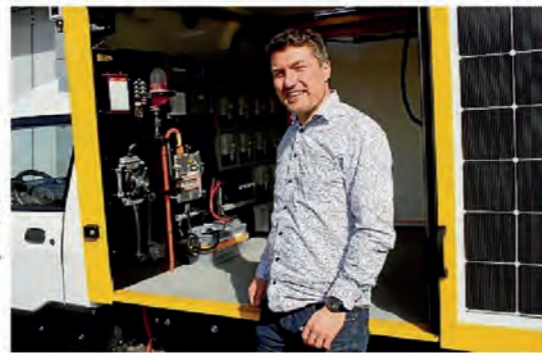
Professor Robby Peibst zeigt das technische Innenleben des Fahrzeugs. Der Solarstrom muss von 12 auf 400 Volt hochtransformiert werden. FOTO: ISP
