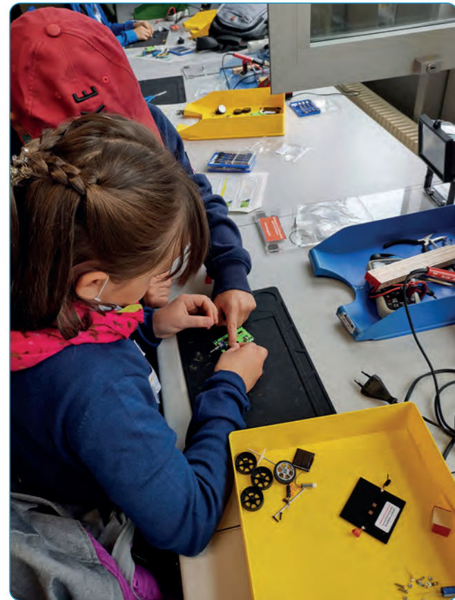
Abbildung/Figure 67: Herstellung des Solarfahrzeugs SUSE-SolarflitzerSC mit 5F Kondensatorspeicher im NILS-Labor.
