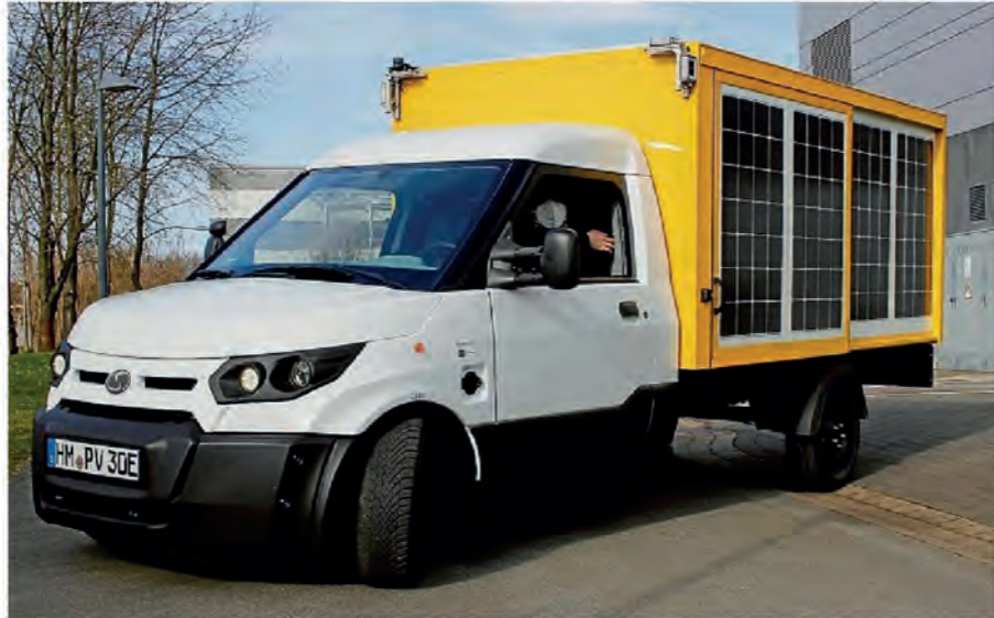
Auf dem Dach und an den Seiten des Streetscooters produzieren Solarzellen Strom für eine Reichweitenverlängerung. FOTO: ISP
