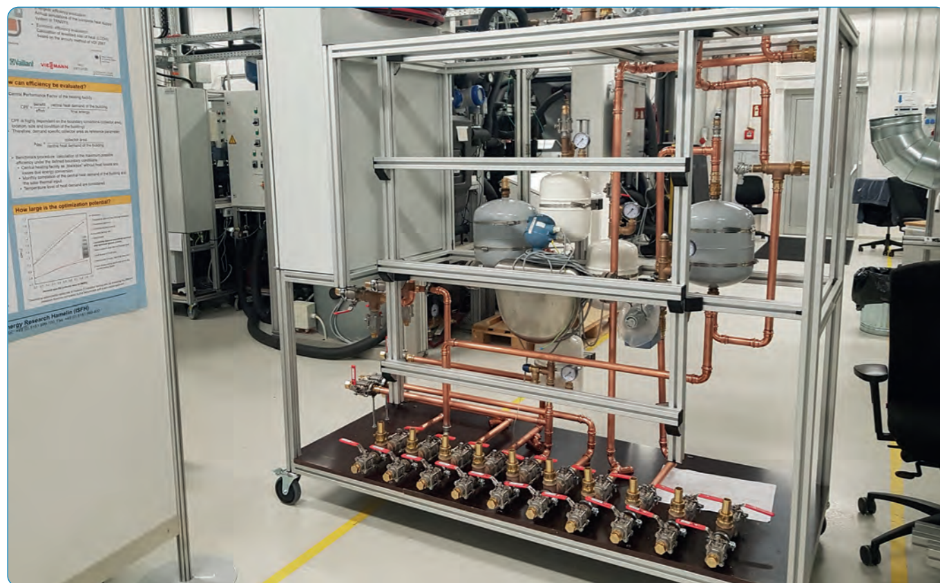
Wohnungsemulator für die kombinierte Prüfung von Trinkwassererwärmung und Heizung von Wohnungsstationen.
