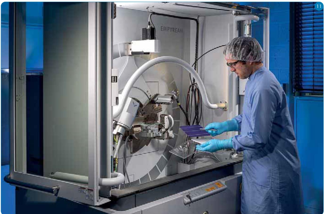
Probenvorbereitung für die Untersuchung im Röntgendiffraktometer (XRD).
