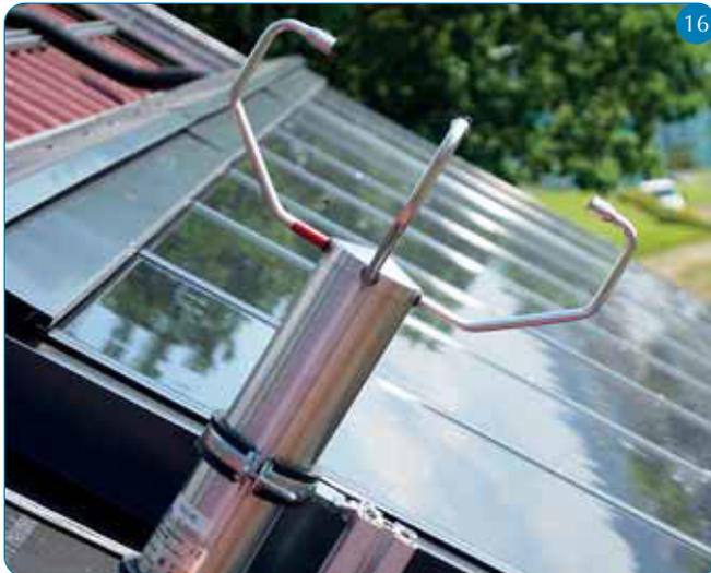
Zweidimensionales Ultraschall-Anemometer zur Erfassung der Windgeschwindigkeit am Testdach. Es gehört zum PV-T-Prüfstand.
