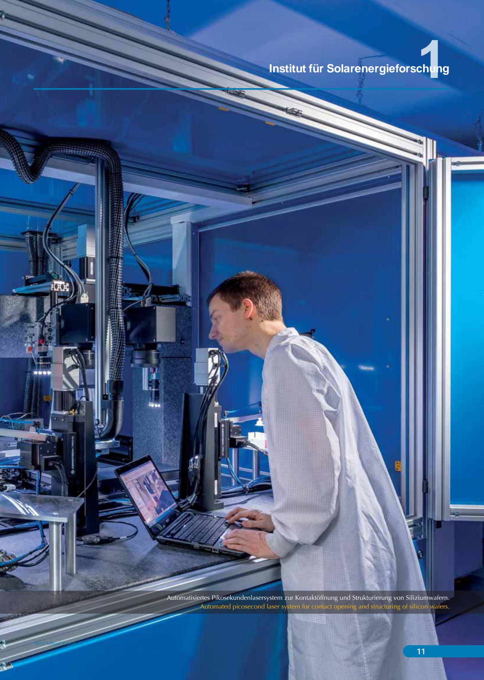
Automatisiertes Pikosekundenlasersystem zur Kontaktöffnung und Strukturierung von Siliziumwafern.
