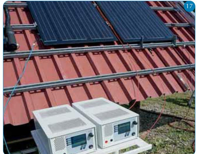
Prüfstand für PV-T-Kollektoren: MPP-Betrieb zweier PV-Module mit elektrischer Last (im Vordergrund). Der Versuchsaufbau umfasst zwei identische PV-Module, wobei das rechte zusätzlich mit einem rückseitigen Wärmetauscher versehen ist (PV-T-Kollektor).
