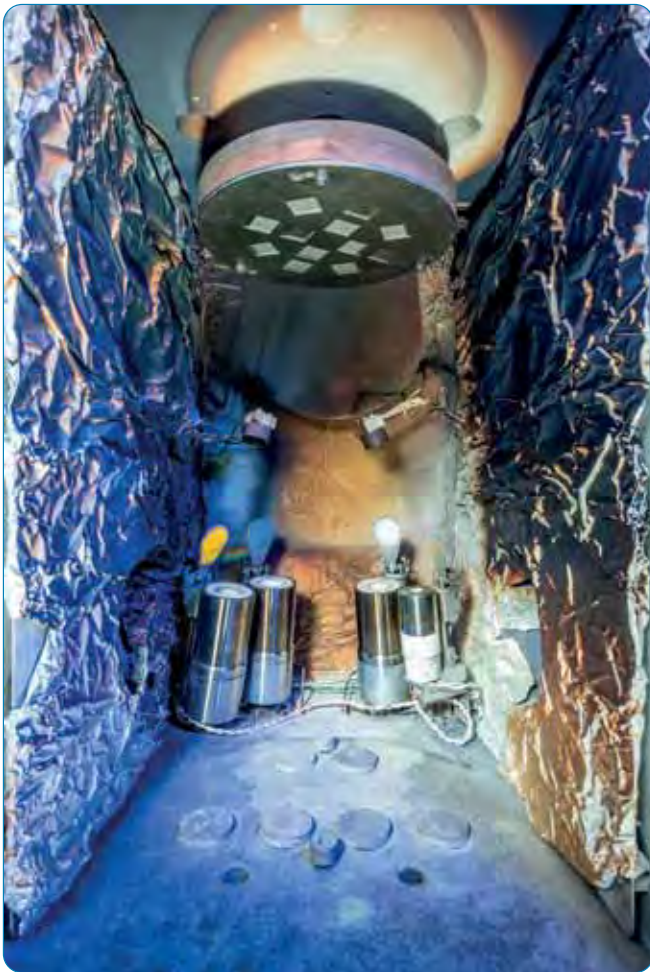
Abbildung/Figure 37: Blick in die Aufdampfkammer der Beschichtungsanlage am ISFH.
