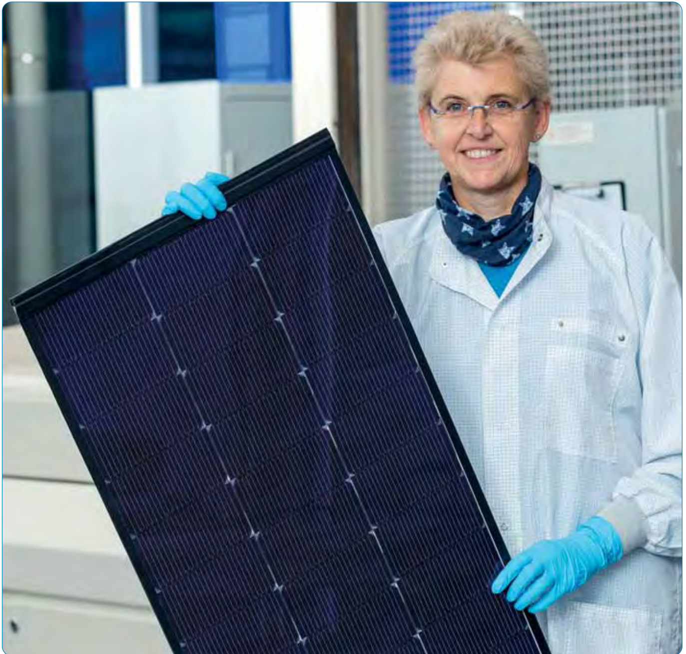
Abbildung/Figure 35: Fotografie des „Proof-of-Concept“-Moduls mit 30 halbgroßen Zellen mit einem Gesamtwirkungsgrad von 21,8%.
