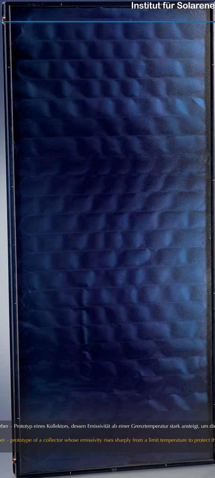
Ein thermochromer Absorber – Prototyp eines Kollektors, dessen Emissivität ab einer Grenztemperatur stark ansteigt, um die Anlage vor Überhitzungsschäden zu bewahren.
