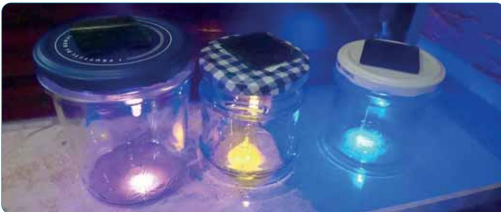
Abbildung/Figure 62: Bunte Solarlampen mit Energiespeicherung. Die Lampen werden von den Schüler\*innen aus Obst- bzw. Gemüsegläsern angefertigt. Die Elektronik mit Speicher und Leuchtdiode ist jeweils im Deckel der Gläser untergebracht.
