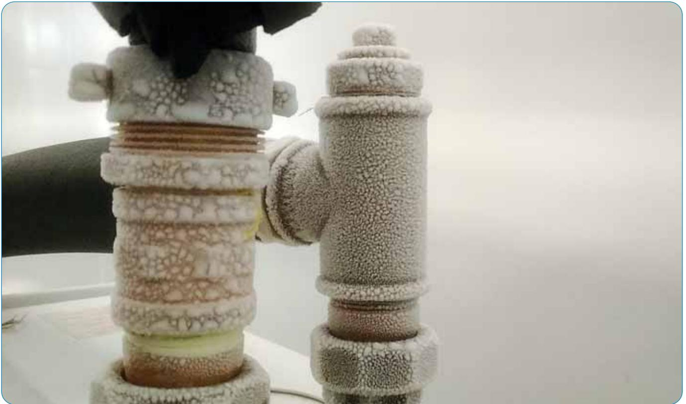
Kondenswasserbildung an einer Soleleitung im Wärmepumpenprüfstand. Mit dieser Leitung wird der Luft der Klimakammer des Wärmepumpenprüfstandes Wärme entzogen.
