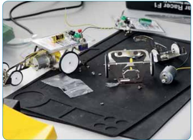
Abbildung/Figure 64: Zusammenbau eines Solarmobils mit einem GoldCap-Kondensator als „Tank“.
