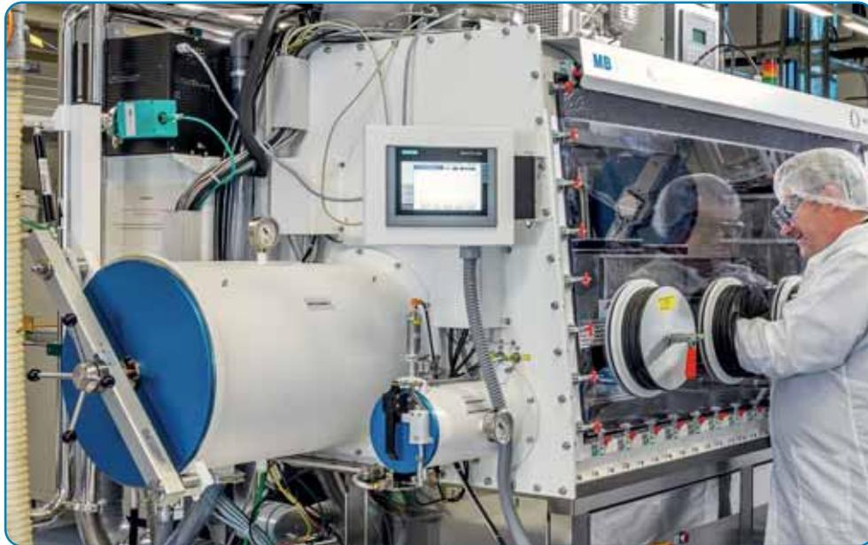
Beschichtung von Siliziumwafern mit flüssigem Silizium in einer Inertgas-Handschuhbox.
