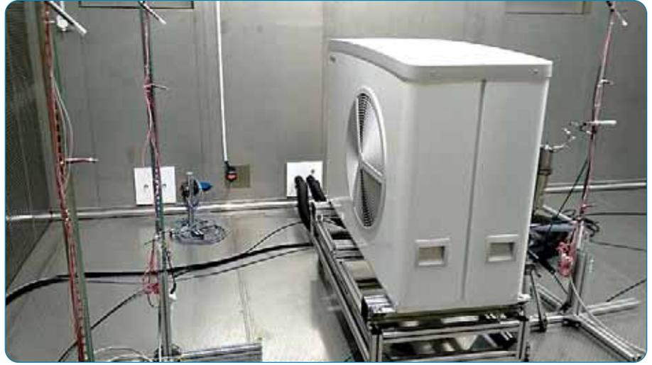
Abbildung/Figure 22: Eine Wärmepumpe im Wärmepumpenprüfstand der „Integrierten Solaren Systemtechnik“.
