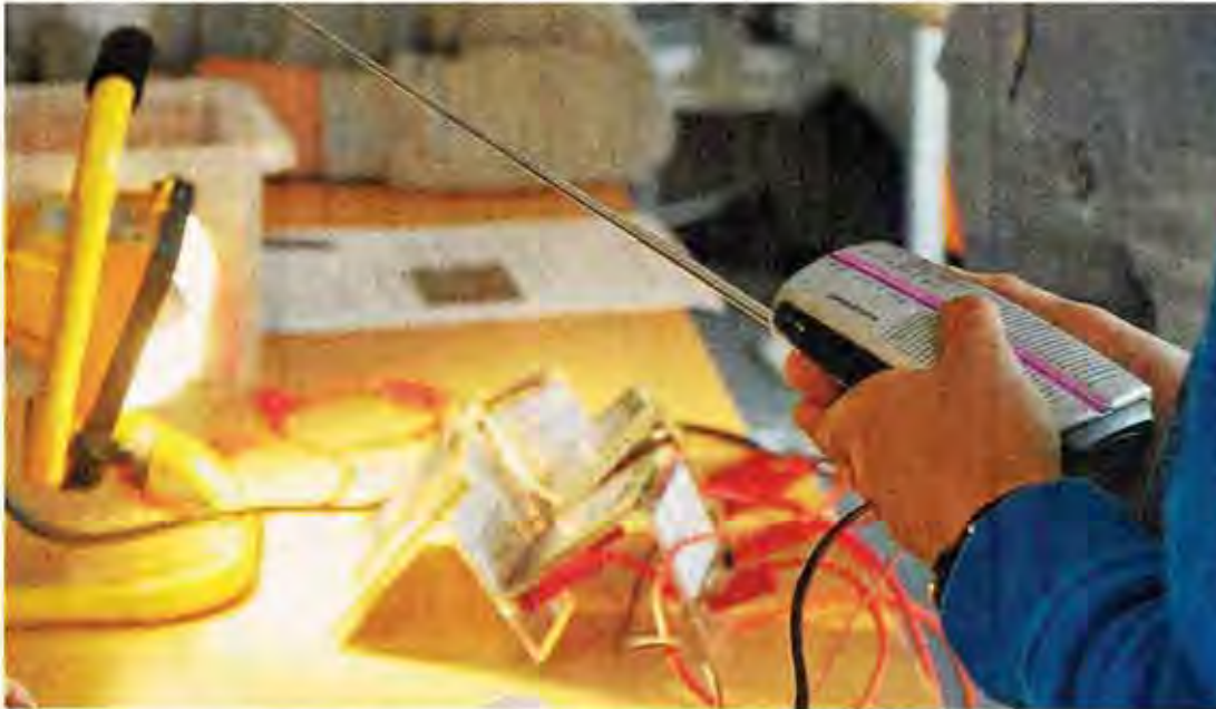
Funktioniert das Radio? Die Schüler müssen herausfinden, wie viele Solarzellen in Reihenschaltung mindestens notwendig sind, damit das Radio Töne aus dem Radio Töne zu entlocken? Dann die Freude bei den Schülern: Tatsächlich ertönt laut und deutlich Musik aus dem Solarradio. Dieses Experiment zur Reihenschaltung von Solarzellen ist nur eine der Stationen, die die Schüler der 5d an diesem Solarforschungstag durchlaufen. In Kooperation mit NILS (Niedersächsische Lernwerkstatt für solare Energiesysteme) vom Institut für Solarenergieforschung Hameln (ISFH) lernen alle fünften Klassen an verschiedenen Tagen so ganz praktisch mehr über Solarenergie – aber auch über Themen wie Erderwärmung und Energiequellen.
