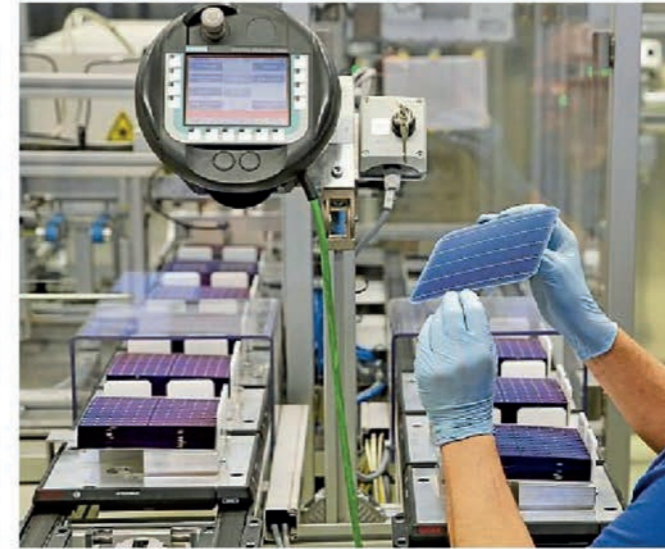
Modulfertigung bei einem früheren Solarzellenhersteller in Sachsen: Inzwischen werden in Deutschland nach Angaben des Institutes für Solarenergieforschung mehr als 90 Prozent der PV-Module importiert.
