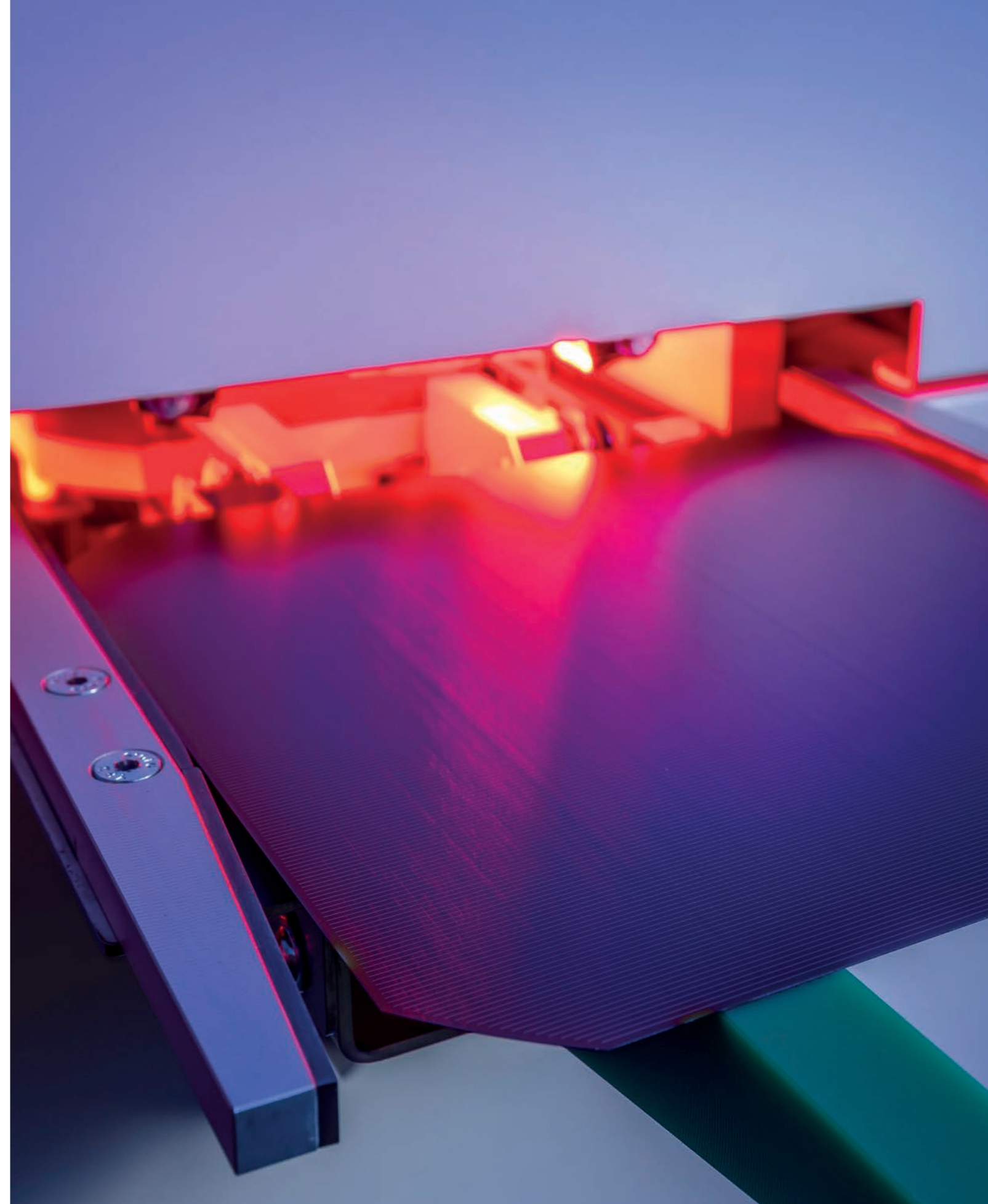
Ein Silizium-Wafer auf dem Weg in den Feuerofen. A silicon wafer on its way into the fast-firing furnace.
