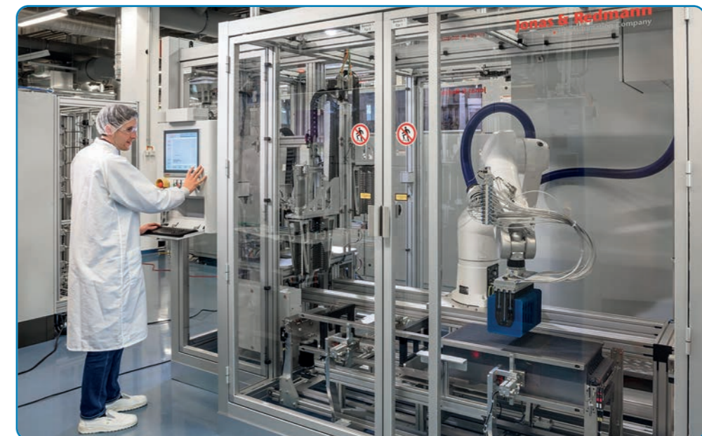
Automatische Beladeeinheit am industriellen PECVD-Ofen im SolarTeC. Automatic loading unit at the industrial PECVD tool in the SolarTeC.
