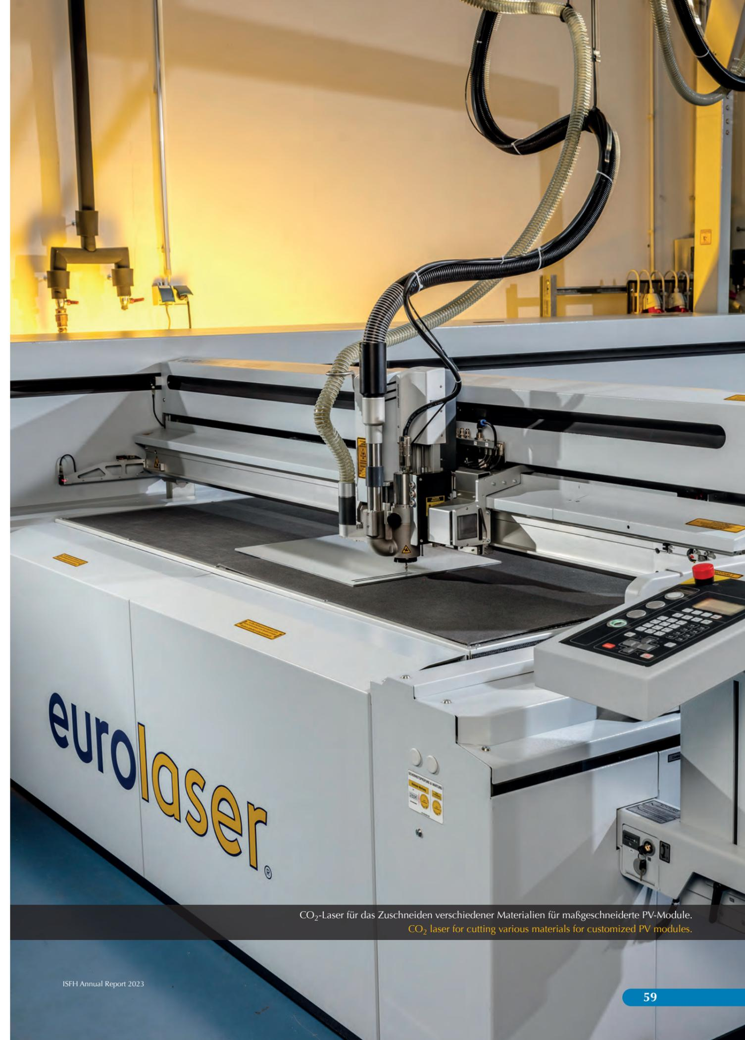
CO<sub>2</sub>-Laser für das Zuschneiden verschiedener Materialien für maßgeschneiderte PV-Module.
