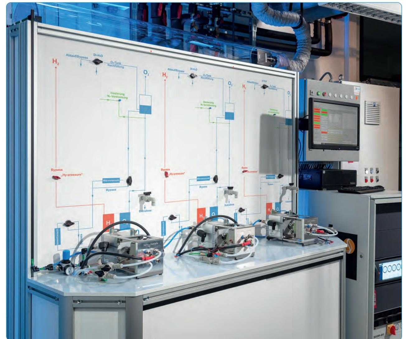
Abbildung/Figure 43: Teststand für die Charakterisierung von Protonen-Austausch-Membran-Elektrolyseuren mit drei Elektrolyse-Zellen.
