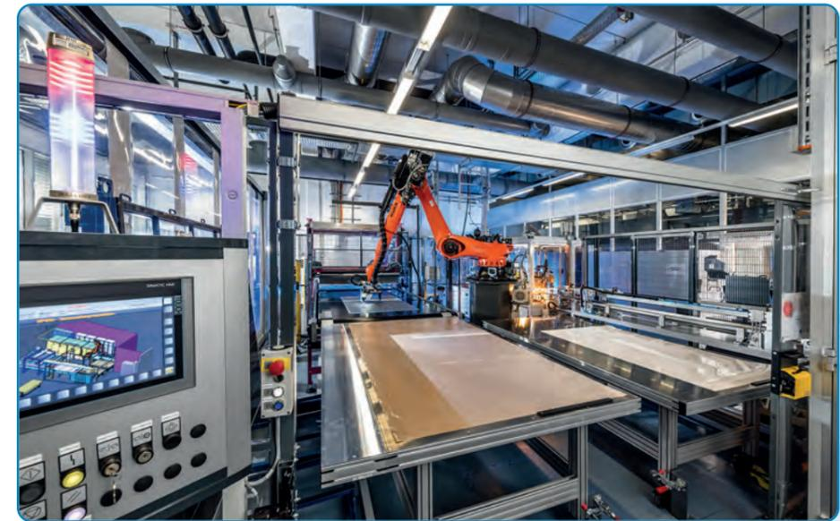
Forschungslinie für die automatisierte Produktion maßgefertigter PV-Module.
