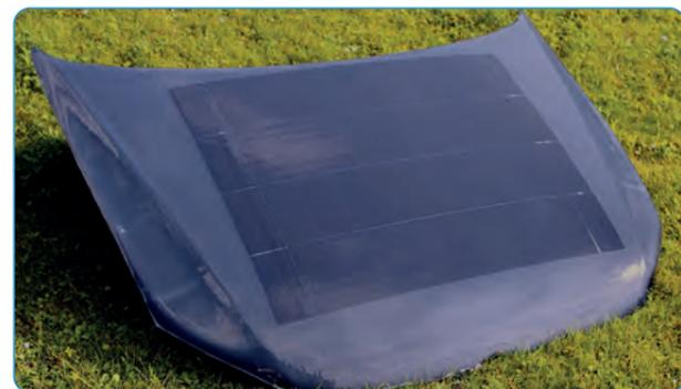
Abbildung/Figure 32: Links: Vorderseite eines VIPV-Moduls auf der Basis einer Pkw-Motorhaube, das mit halbierten Rückkontakt-Solarzellen ausgestattet ist, was zu einem farblich einheitlichen Erscheinungsbild führt. Rechts: die Rückseite mit der Stützstruktur.
