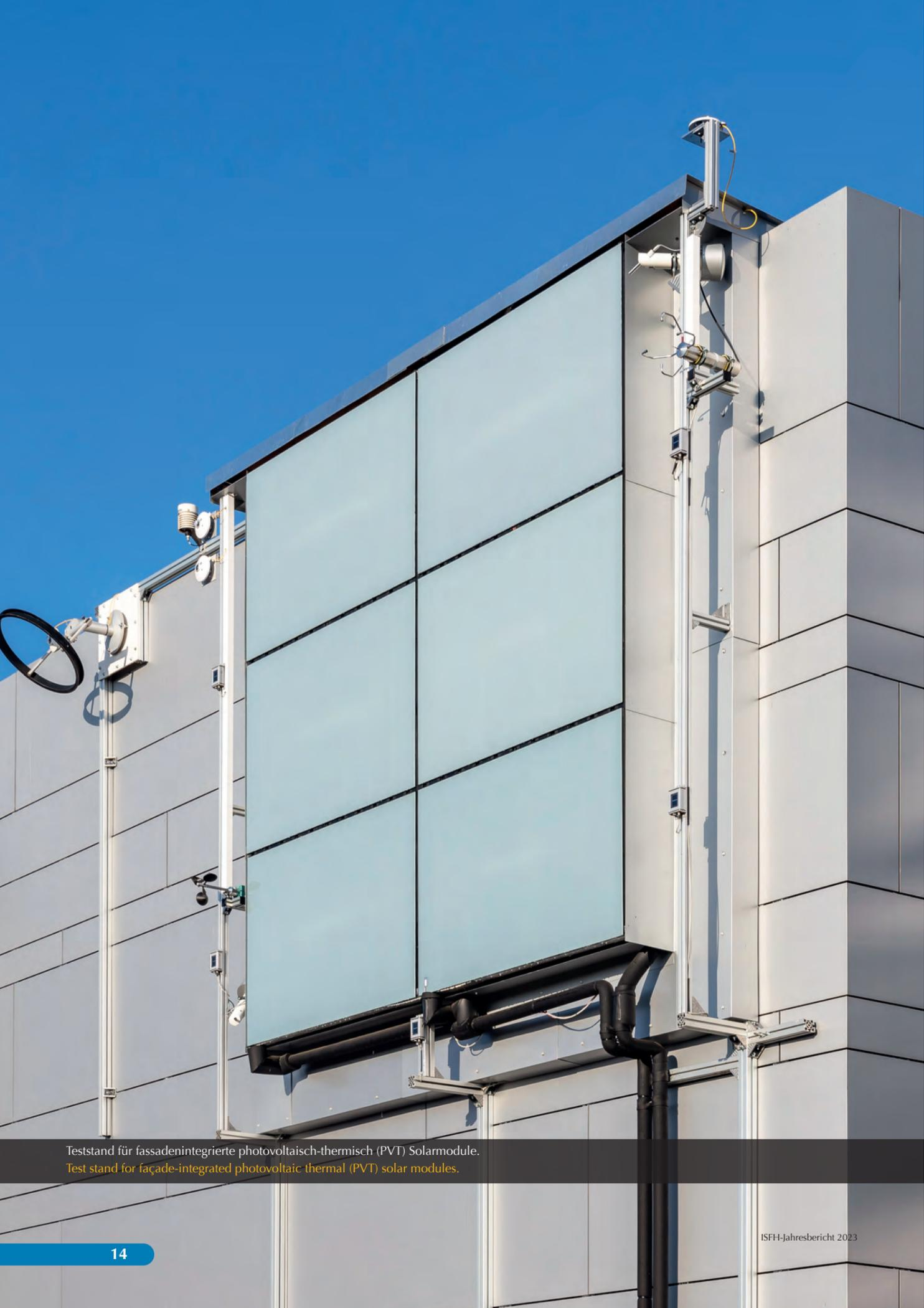
Teststand für fassadenintegrierte photovoltaisch-thermisch (PVT) Solarmodule.
