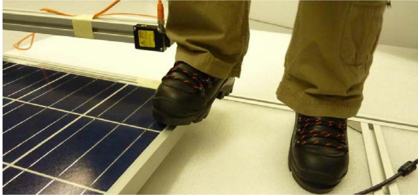
**Abb. 29: Belasten der Rahmenecke.**
