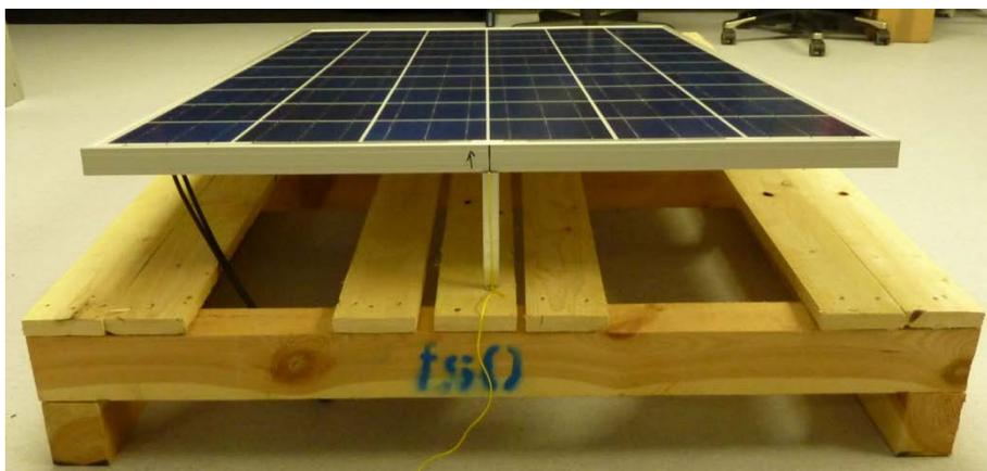
**Abb. 35: Modulkipptest Sunny-side up.**
