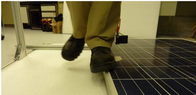
**Abb. 30: Belasten Rahmen in der Mitte der langen Seite.**
