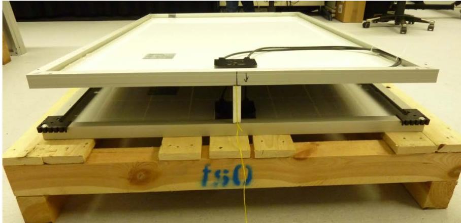
**Abb. 34: Modulkipptest Sunny-side down.**
