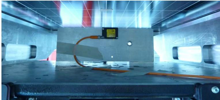
**Abb. 8: Auf Shaker montiertes Modul mit Laserdistanzaufnehmer unter der Modulmitte.**
