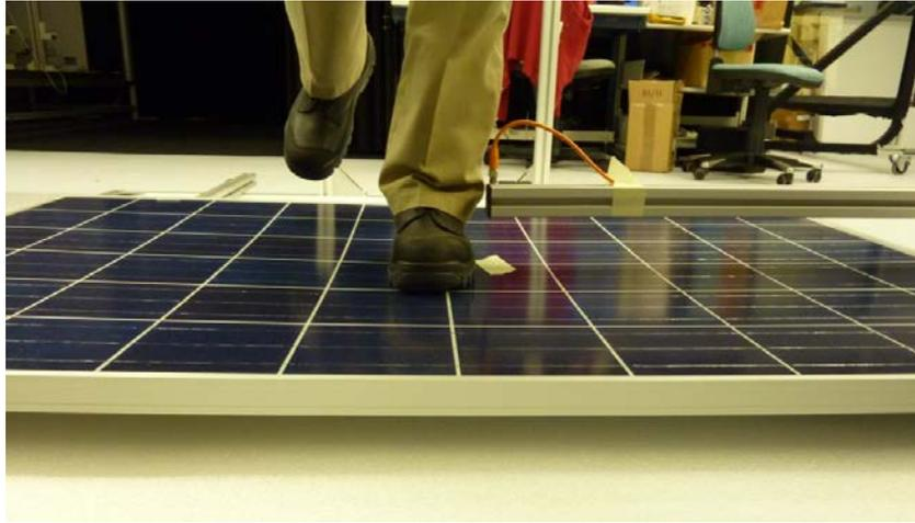
**Abb. 31: Belasten der Modulmitte.**
