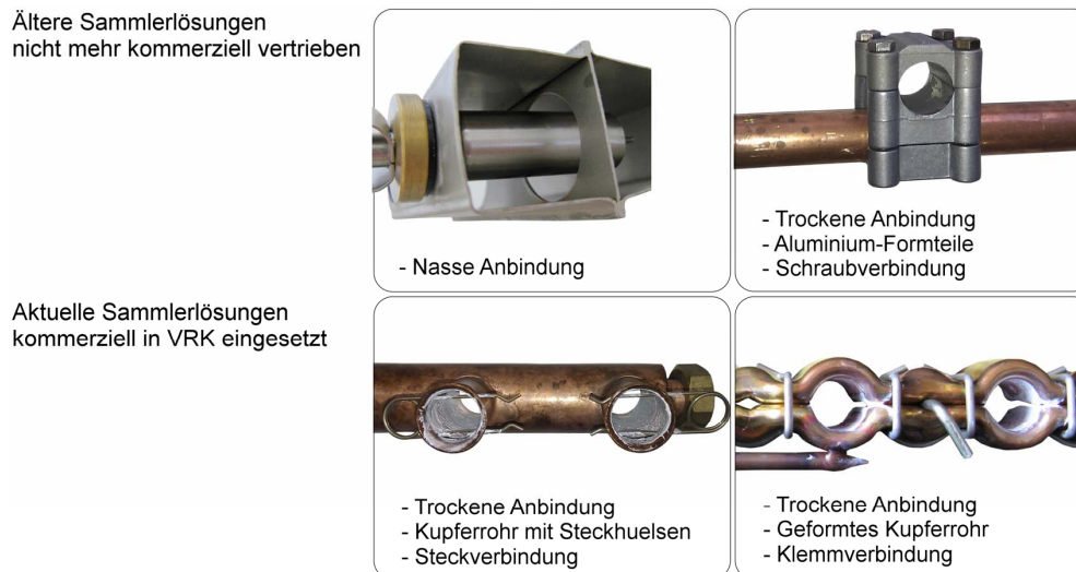
Abbildung 2.2: Beispiele der thermischen Anbindung von Wärmerohrkondensatoren an das im Sammelrohr fließende Solarkreisfluid. Bei den trockenen Anbindungen kommt Wärmeleitpaste im Spalt zwischen Kondensator (nicht dargestellt) und Sammelrohr zum Einsatz.
