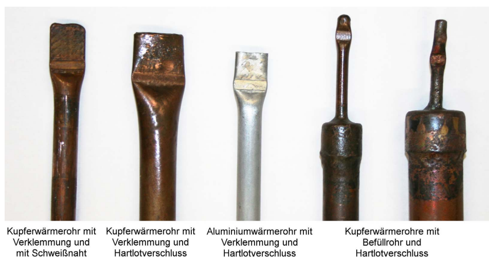
Abbildung 5.4: Innerhalb der Prototypenfertigung angewendete Verschlussstechniken mit Verklebung und damit Verschluss des Dampfraums im Wärmerohr gegenüber der Umgebung und folgender Abdichtung durch WIG-Schweißen oder Hartlöten
