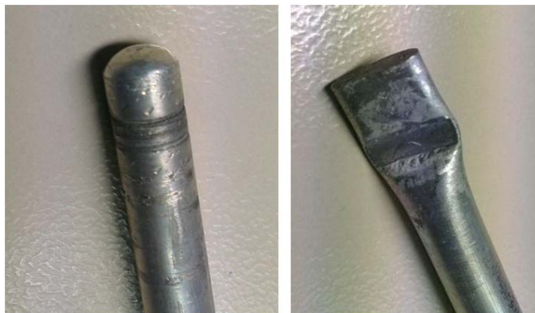
Abbildung 7.9: Untersuchte Verschlusstechniken für die Herstellung von Aluminium-Wärmerohren, WIG-Schweißen (links) und Hartlötung mit linearer Verquetschung des Wärmerohrs (rechts)
