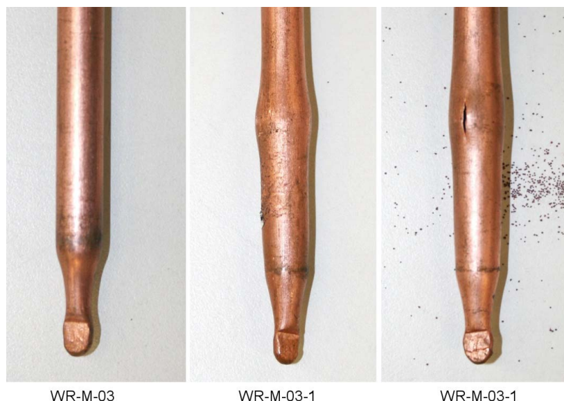
Abbildung 4.22: Unbeschädigtes Wärmerohr WR-M-03 und Frostschäden an Wärmerohren WR-M-03-1 nach Frostbelastung in der Klimakammer
