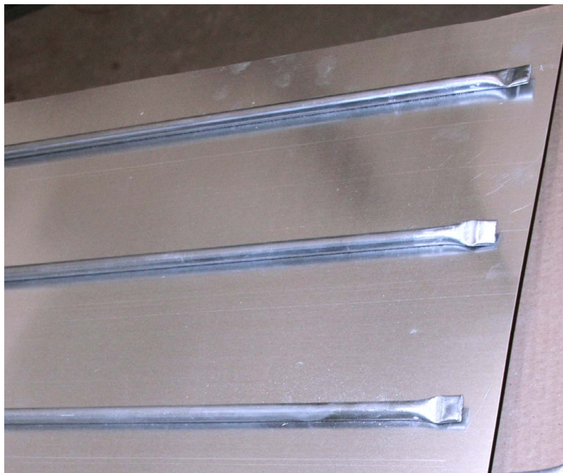
Abbildung 8.8: Ausschnitt der Rückseite unten des Absorbers mit Aluminium-Absorberblech sowie per Laserschweißverfahren mit dem Absorberblech verbundenen Aluminium-Wärmerohren
