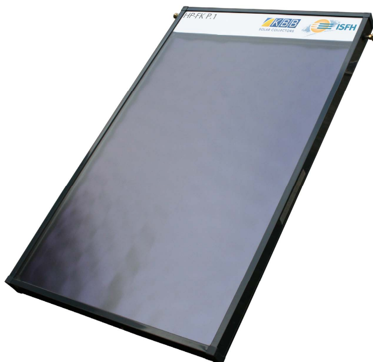
Abbildung 8.9: Flachkollektor-Prototyp mit Gravitationswärmerohren und einer von der Absorberoberfläche getrennten Sammlerausführung zur Minderung der Solarkreisfluidtemperatur im Stagnationsfall
